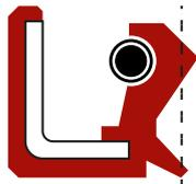
Diseños simples, de aplicación convencional. La diferencia principal es la conformación del diámetro exterior, que puede ser de caucho o metal.
